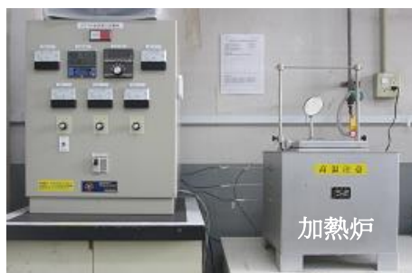
図2 ASTM 発火試験機（加熱炉最大温度：600°C）
