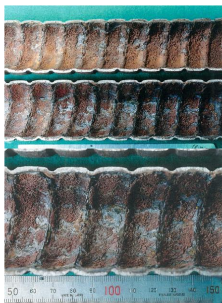
チューブ内面の腐食状況
