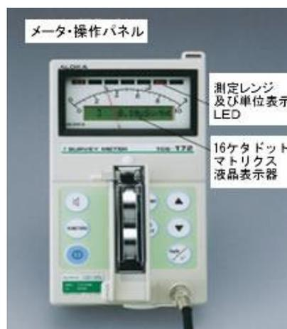
NaI (TI) シンチレーションサーベイメータ（TCS-172B 日立アロカメディカル社製）
